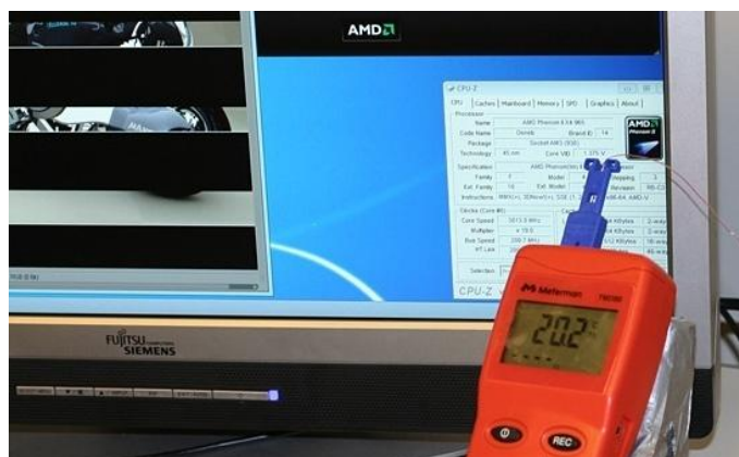
Kuva 4.15. Mikroprosessorin T_c -lämpötilaksi mitattu 20,2 celsiusastetta.
