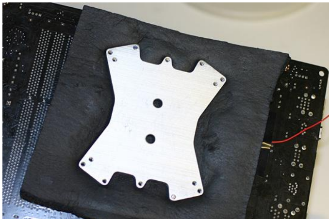
Kuva 4.5. Emolevyn eristys takapuolelta Armaflex-solumuovimatolla.
