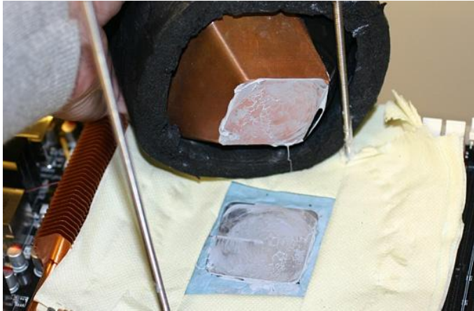
Kuva 4.10. Lämpötahna testien jälkeen levinneenä kulhon ja mikroprosessorin väliin.
