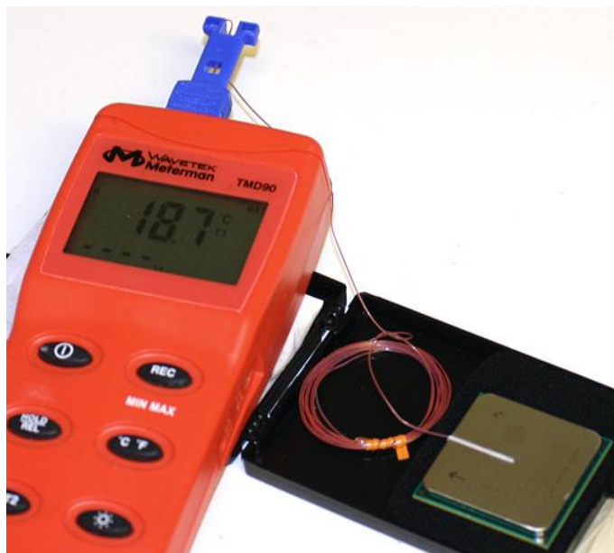
Kuva 4.2. Mikroprosessorin geometriseen keskikohtaan liitetty lämpötila-anturi.
