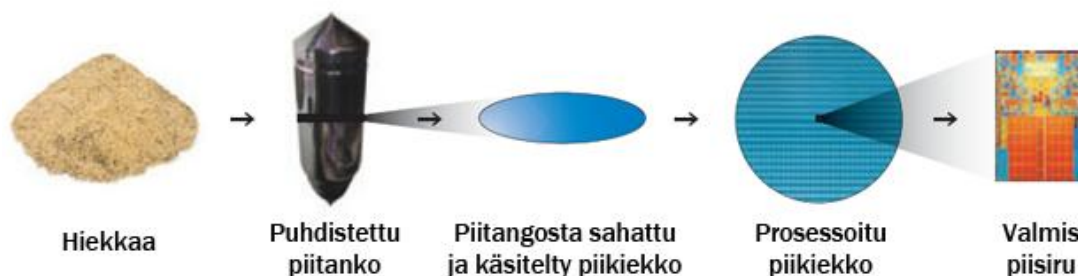
Kuva 2.7. Mikroprosessorin valmistus yksinkertaistettuna.
