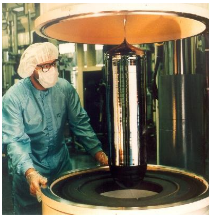
Kuva 2.10. Czochralskin menetelmällä valmistettu piikide [32].
